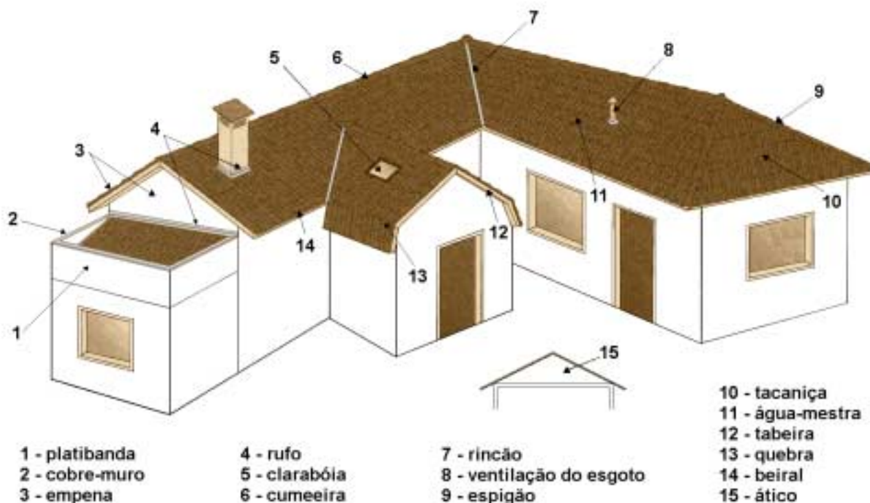
Figura 2: Linhas e partes integrantes dos telhados.
